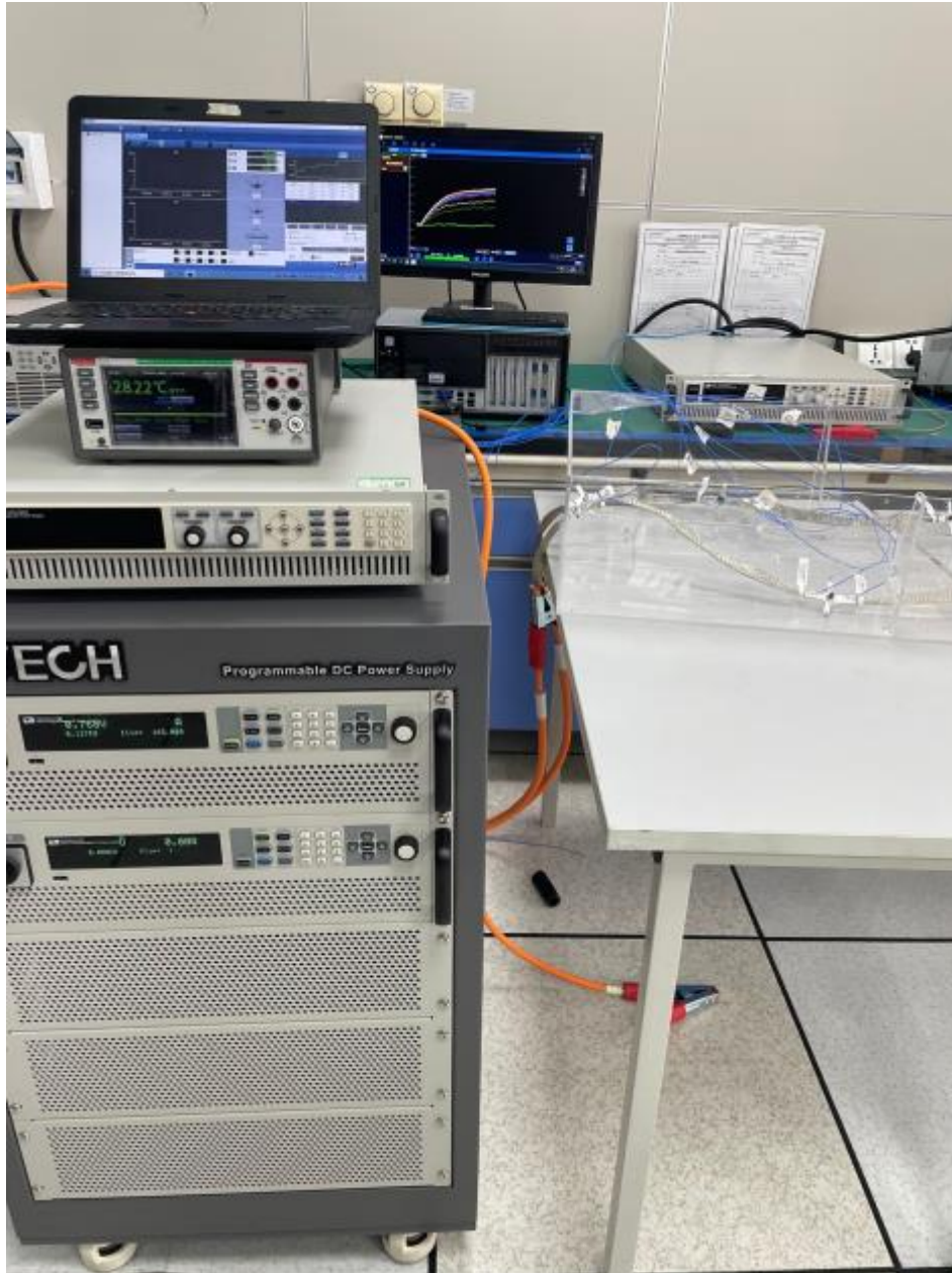
图一 IT6000C 用于汽车线束老化测试
