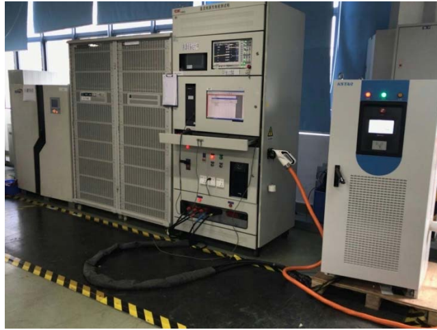
图一、IT8900 为直流充电桩进行测试
