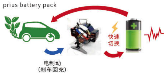
图 3 电动汽车刹车电流回充电池
