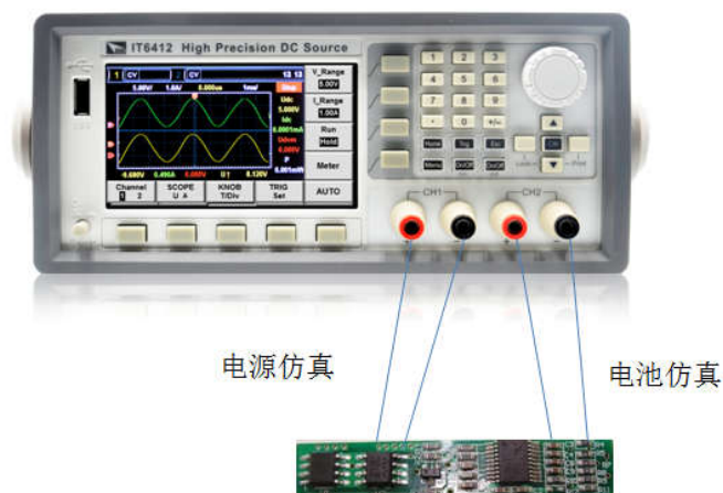
图 4 IT6412 锂电池保护板测试连接举例示意图
